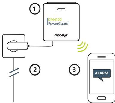
Der Mobeye CM4100 überwacht Stromausfall und angeschlossene Fehlerkontakte. Der Alarmmelder sendet sofort eine Benachrichtigung, wenn sich der Status ändert. Auf diese Weise haben Sie die volle Kontrolle.
