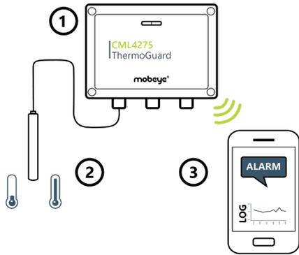
Der Mobeye CML4275 misst die Temperaturwerte kontinuierlich, meldet sich im Alarmfall sofort und protokolliert die Werte periodisch. Für den professionellen Anwender bietet dies einen vollständigen Einblick in das Temperaturprofil.
