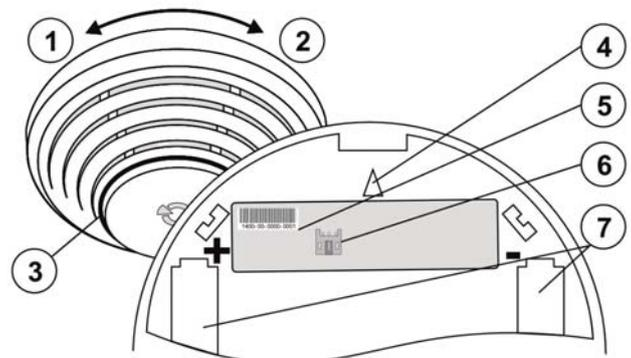
Abb. 6: 1 – Öffnen der Abdeckung des Melders; 2 – Schließen der Abdeckung des Melders; 3 – optische Statusanzeige; 4 – Pfeil zeigt an, wo der Melder eingesteckt werden muss; 5 – Seriennummer; 6 – Anschluss für externe Antenne; 7 – Batteriehalterungen;
