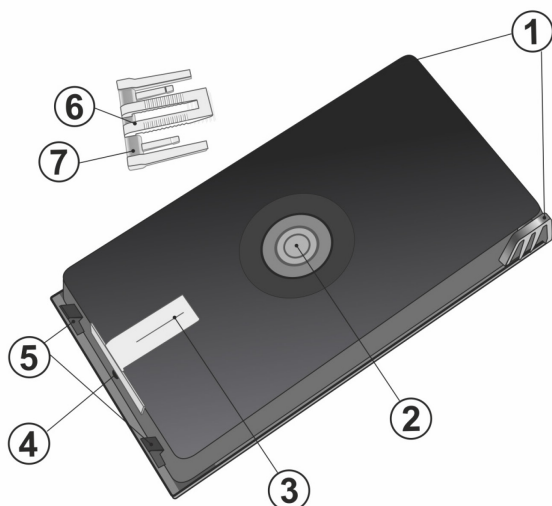
Fig. 1 : Touche de détresse dans sa plateforme de montage : 1. Charnières, 2. Touche A, 3. Commutateur B, 4. Vis de fixation de la plaque arrière, 5. Loquets de la plateforme de montage, 6. Clip pour les billets de banque ou documents, 7. Guide optique LED
