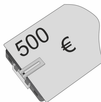
Fig. 2 : Touche de détresse équipée d'un porte-billets
