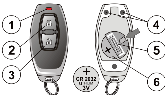
Abbildung: 1 – Signallampe; 2 – Taste zur Sicherung (Ein); 3 – Taste zum Entschärfen (Aus); 4 – Schrauben der unteren Abdeckung; 5 – Seriennummer; 6 – Batterie CR2032 (entfernen Sie die Batterie durch Drücken in Pfeilrichtung).
