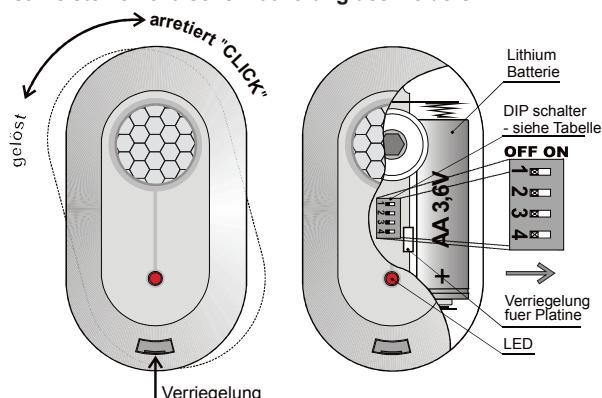
1. Lösen Sie die untere Halterung des Melders (durch Drehen)
