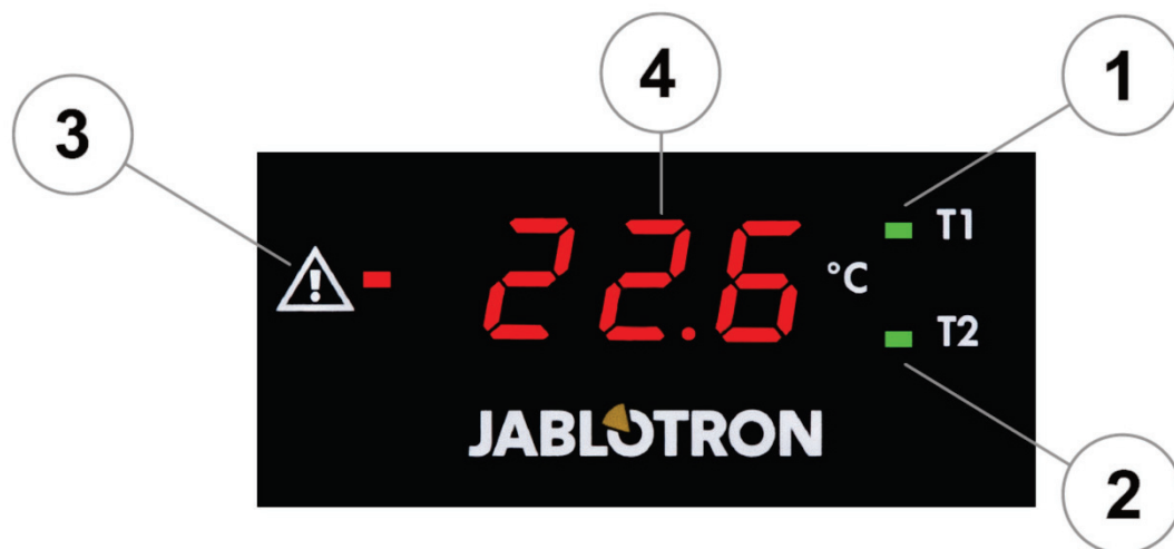
Figure 4: description de l'écran: 1 - LED 1 (indique l'état du capteur T1); 2 - LED 2 (indique l'état du capteur T2); 3 - LED 3 (avertissement / fermeture / ouverture dans la logique négative / relais); 4 - Écran
