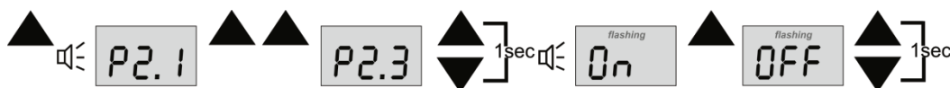
Figure 6. Exemple de réglage du paramètre P2.3 après l'activation du thermomètre et avec le mode F2 sélectionné
