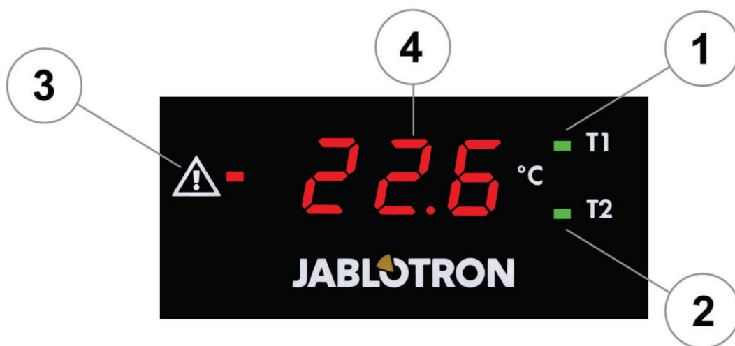
Afbeelding 4: beschrijving van het beeldscherm: 1 - LED 1 (geeft de status van de sensor T1 aan); 2 - LED 2 (geeft de status van de sensor T2 aan); 3 – LED 3 (waarschuwing / sluiting / opening in de negatieve instelling van de logica / relais); 4 – Beeldscherm
